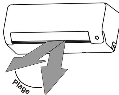
**NOTE :** Ne pas déplacer le volet à la main. Cela entraînera la désynchronisation du volet. Si cela se produit, veuillez éteindre l'unité et le débrancher pendant quelques secondes, puis redémarrer l'unité. Cela réinitialisera le volet.
