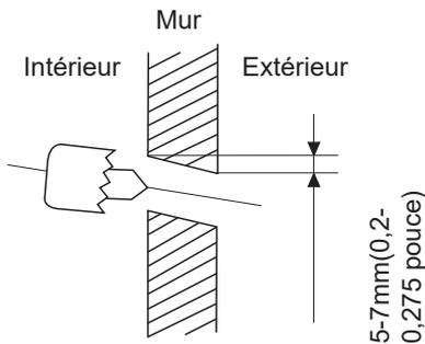
**NOTE :** Lorsque le tuyau de raccordement à côté gaz est de  $\Phi 16\text{mm}$  (5/8 pouce) ou plus, le trou dans le mur doit être de 90mm (3.54 pouces).
