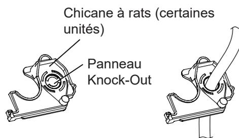
**NOTE** : Si la taille du câble est trop grande, retirez le petit panneau en plastique du milieu pour créer une fente par laquelle le câble peut sortir. Si vous souhaitez retirer le châssis ou le tuyau de vidange, veuillez d'abord retirer la chicane à rats.
