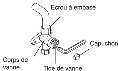
12. À l'aide d'une clé hexagonale, ouvrez complètement les vannes à haute pression et à basse pression.
